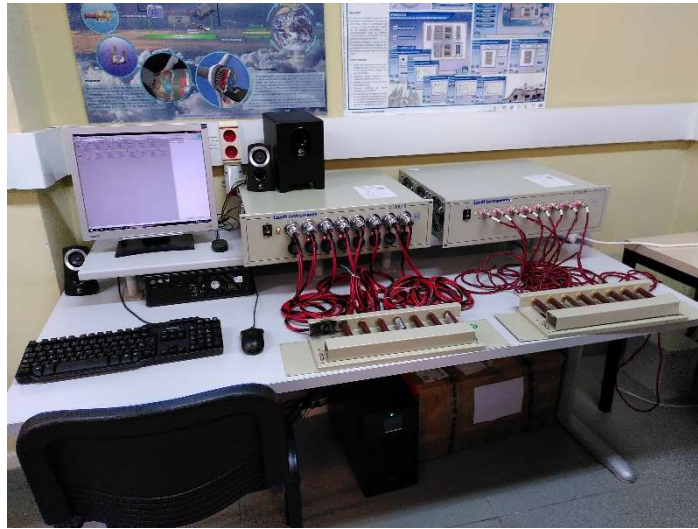
Figura A-2. Cicladores CT3001B junto con el ordenador para su control.
