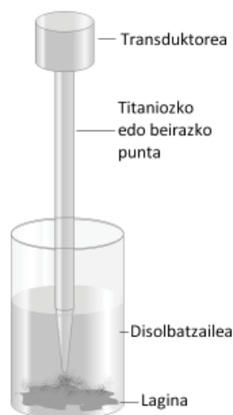
2.18. irudia. Laginaren gainean zuzenean irradiatzen duen ultrasoinu zundaren eskema.
