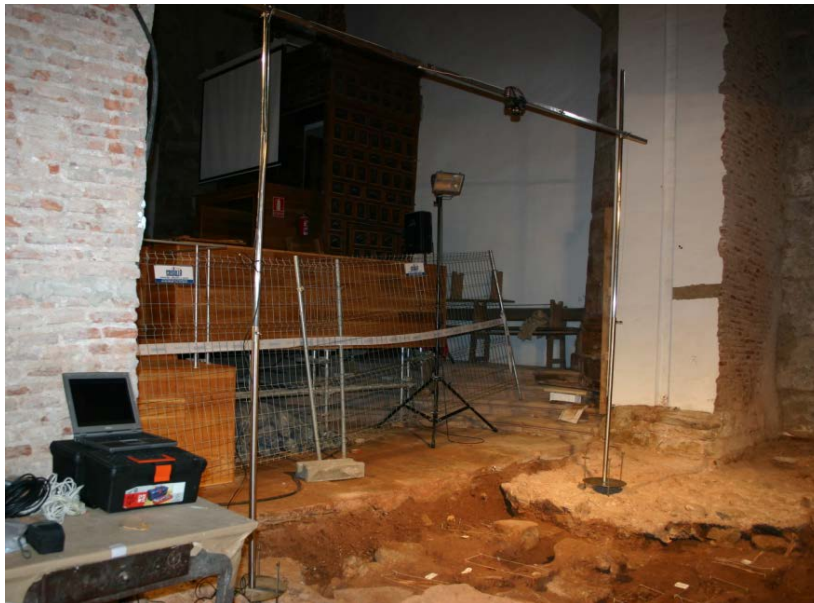
Fig.13 Sistema utilizado para la documentación fotogramétrica.
