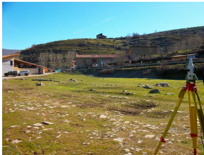
Fig. 9.- Disposición de la estación total en el centro de las eras, para la observación de las redes de apoyo y topográfica.
