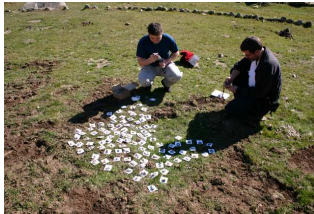
Fig. 6.- Preparación de las dianas para el apoyo fotogramétrico.
