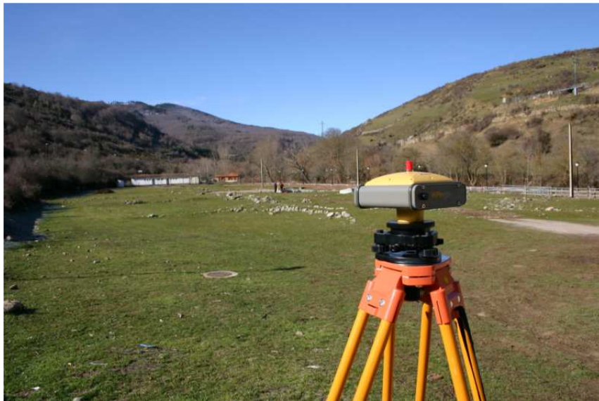
Fig. 3.- Receptor GNSS en Base nº 1
