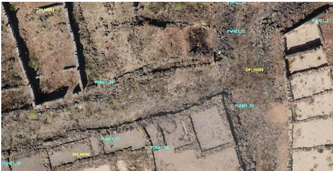
Fig.31.- Control geométrico de las ortofotografías.
