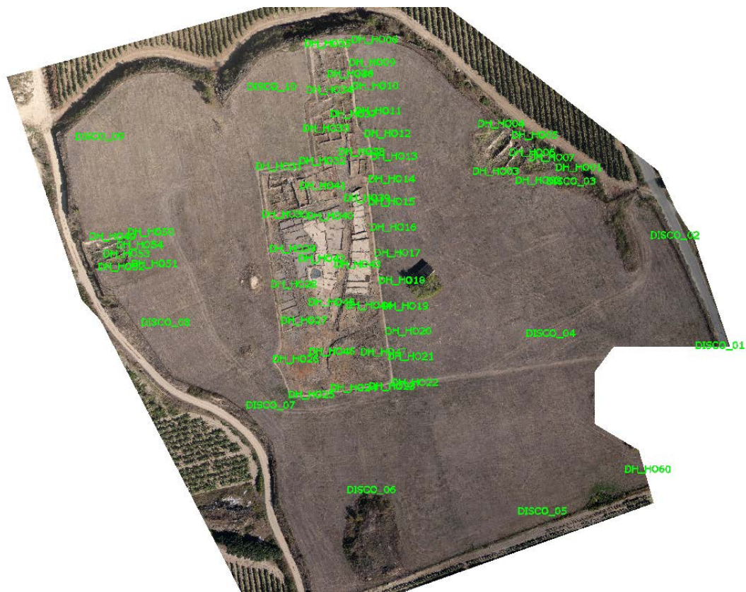
Fig.16.- Distribución del apoyo fotogramétrico.
