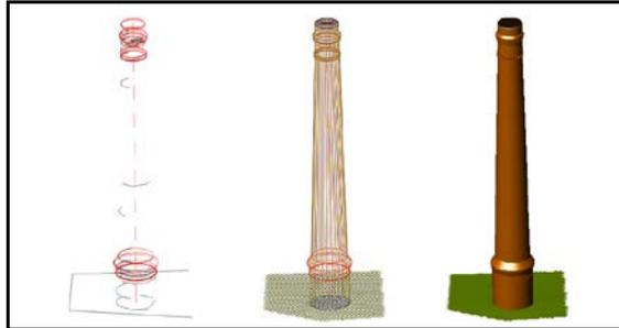
Figura 10: Ejemplo de una chimenea medida con Estación total y mallada para generar el modelo
