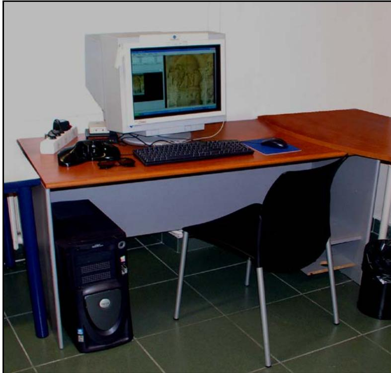
Figura 25: Estación Fotogramétrica Digital SoftPlotter.
