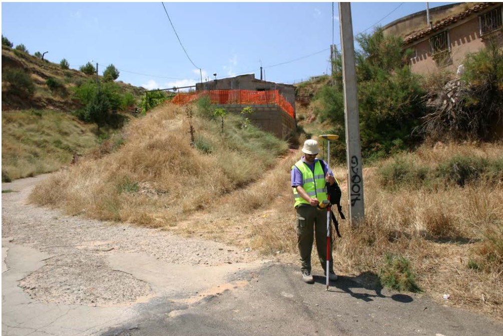
Imagen 8. Toma de datos del perímetro del yacimiento mediante GPS.
