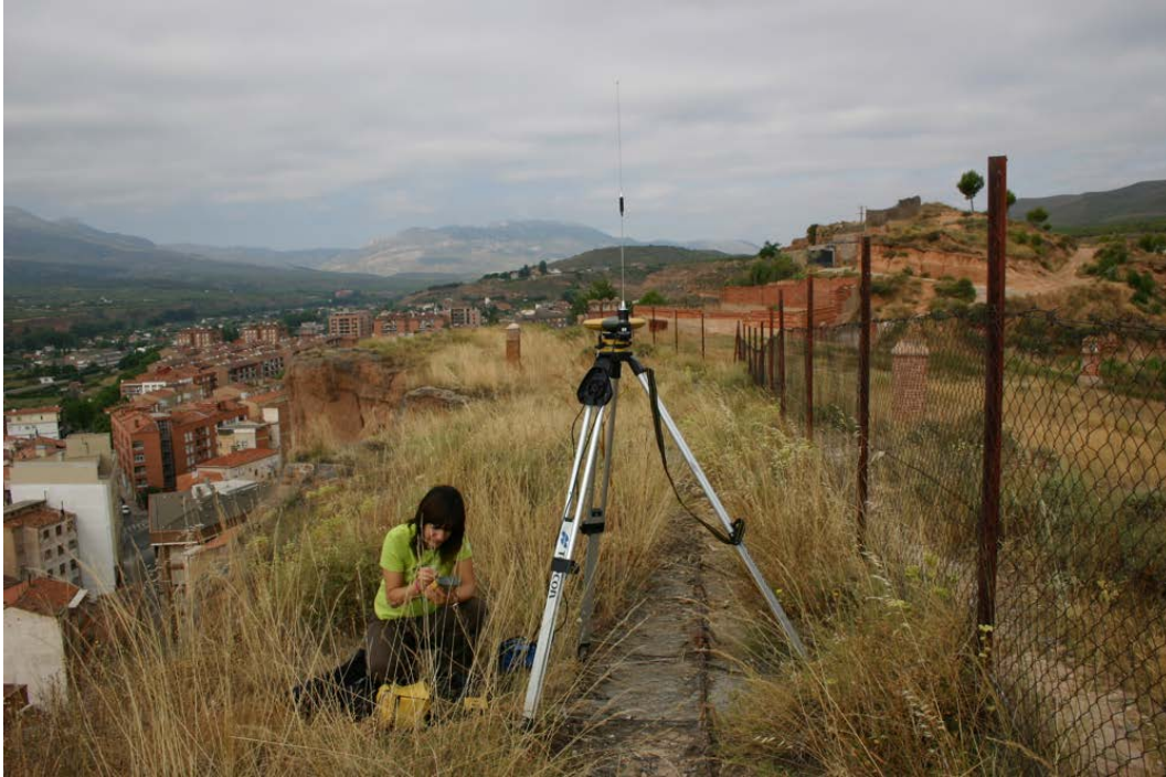
Imagen 6. Estación de referencia GPS y utilizada para la obtención de coordenadas.
