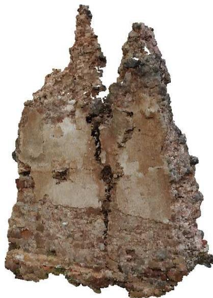
*Imagen 7.4. Nube de puntos de los paños Sur y Este y modelo del paño Sur del muro "P" en Photomodeler Scanner*
