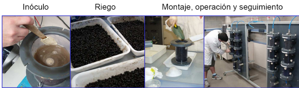
Figura 9.4. Procedimiento para puesta en marcha de la planta de biofiltración.
