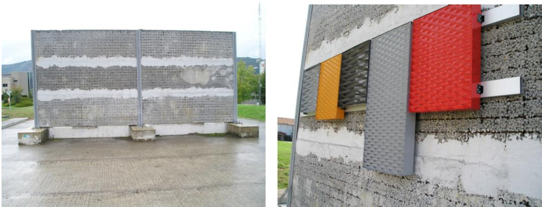
Figura 1. A la izquierda, la cara norte del muro de hormigón que sostiene los paneles. A la derecha, distribución y anclaje de los paneles de la cara norte.
