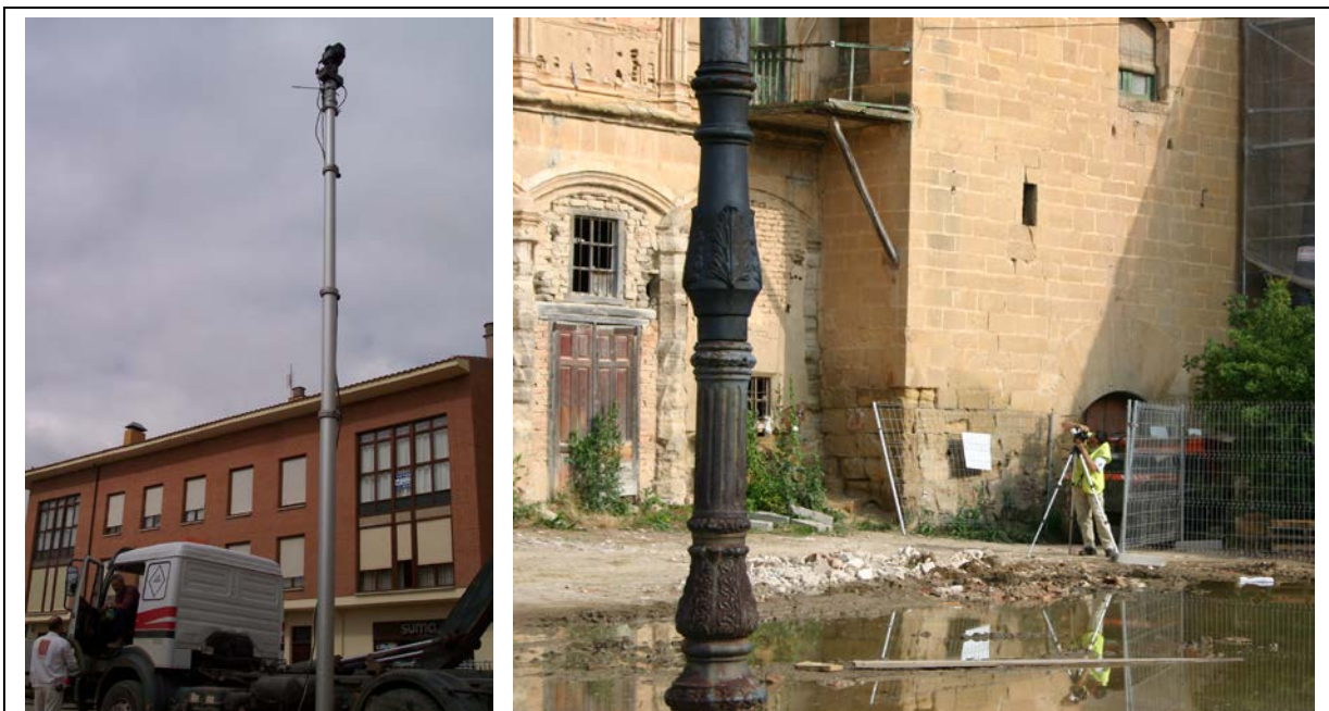
Fig. 9.- Toma de pares estereoscópicos, a la izquierda utilizando un jalón telescópico para evitar obstáculos y a la derecha sobre trípode para garantizar la estabilidad de la de la toma en las zonas inferiores.
