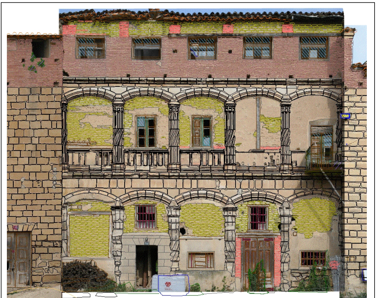
Fig. 15.- Restitución fotogramétrica con ortoimagen de fondo.
