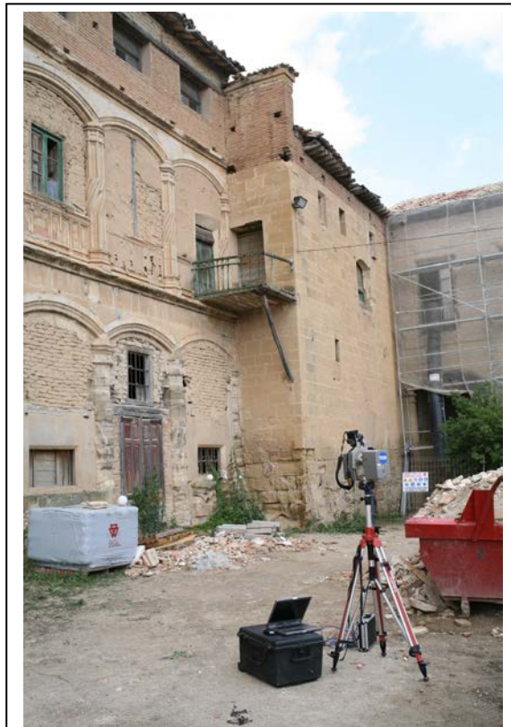
Fig. 16.- Escáner tridimensional durante la toma de datos.
