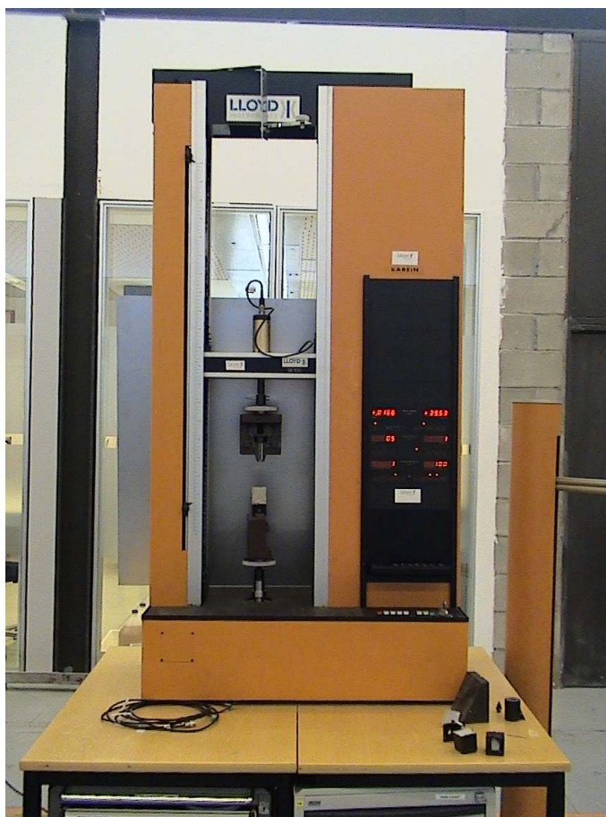
3.3 Irudia: Zuntzen erauzketarako entsegu-makina.
