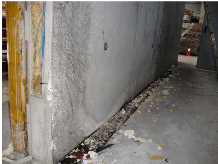
4.5 Irudia: Tutuaren muturreko forma moldeatua ponpaketa presioa dela eta.
