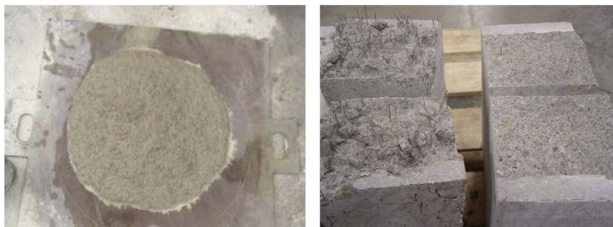
(a) Hormigoi autotrinkotzailea (HAT) (b) Altzairu zuntzez indartutako hormigoia (AZIH)
