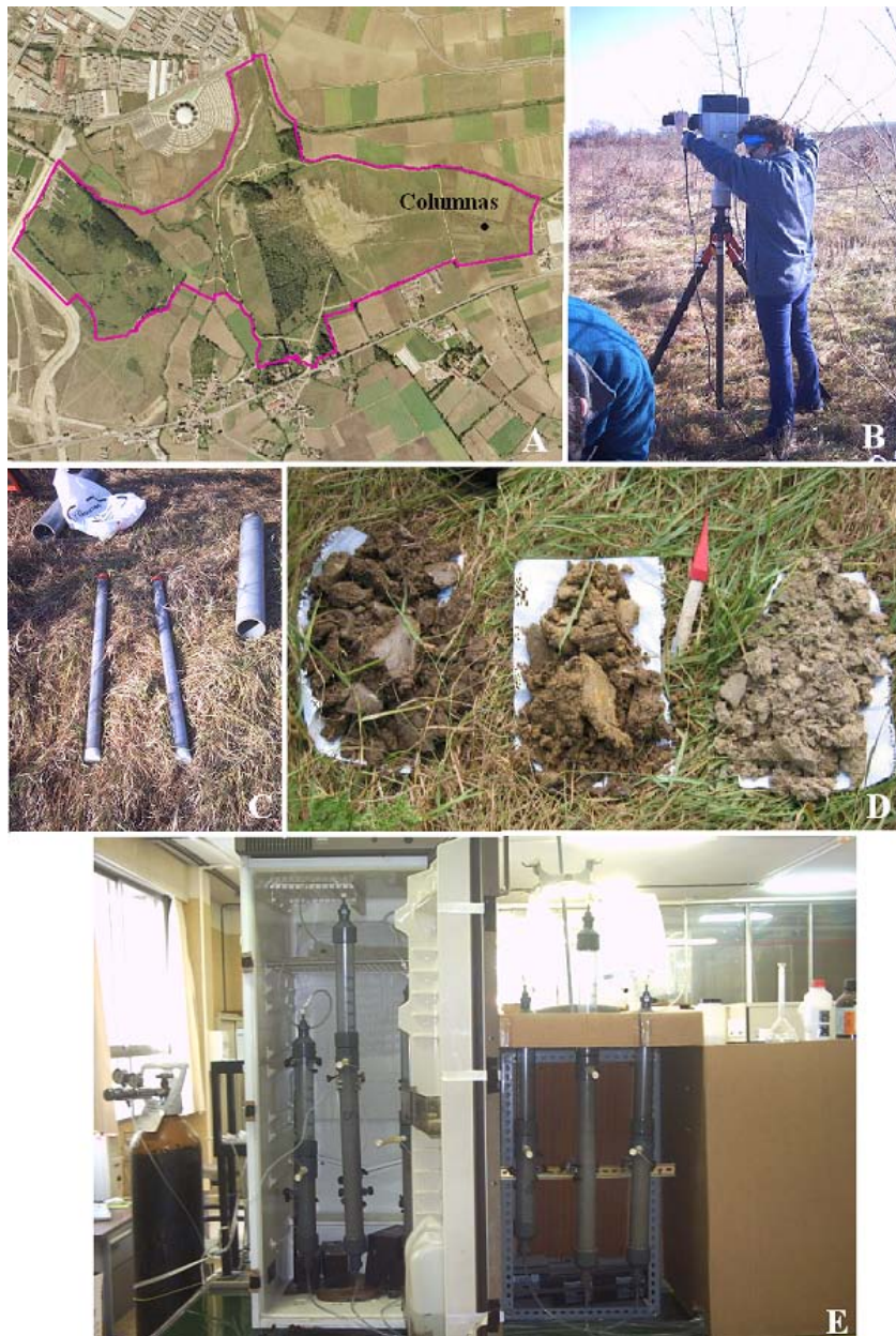
Figura 4.3. Localización, extracción y montaje final de las columnas inalteradas de lixiviación. Fuente: Sigpac (A), propias (B,C,D,E).
