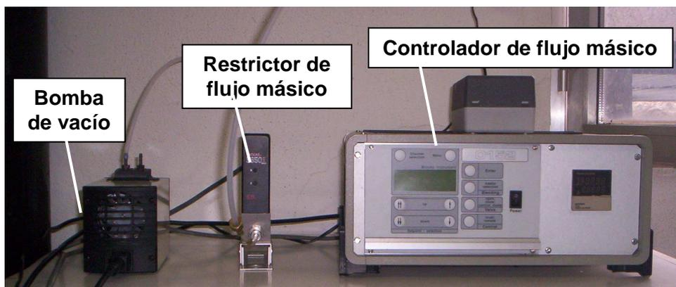
**Figura 3.5. Equipos complementarios del sistema de muestreo en tubos rellenos de adsorbente. Bomba de vacío, restrictor y medidor de flujo másico**
