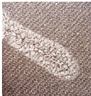
74 / Deterioro en una impresión con corindón por manipulación previa al secado completo.
