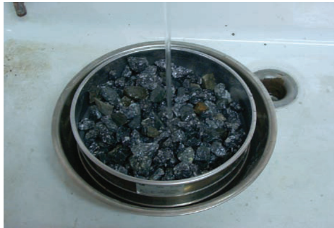
54 / Proceso de limpieza de un árido. Imagen cortesía de LOEMCO. Laboratorio Oficial para Ensayo de Materiales de Construcción.
