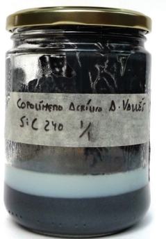
70 / Decantación del árido transcurridos diez días desde la fabricación del compuesto.
