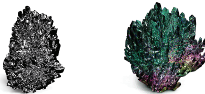
56 / Muestras de carburo de silicio negro y carburo de silicio verde.
