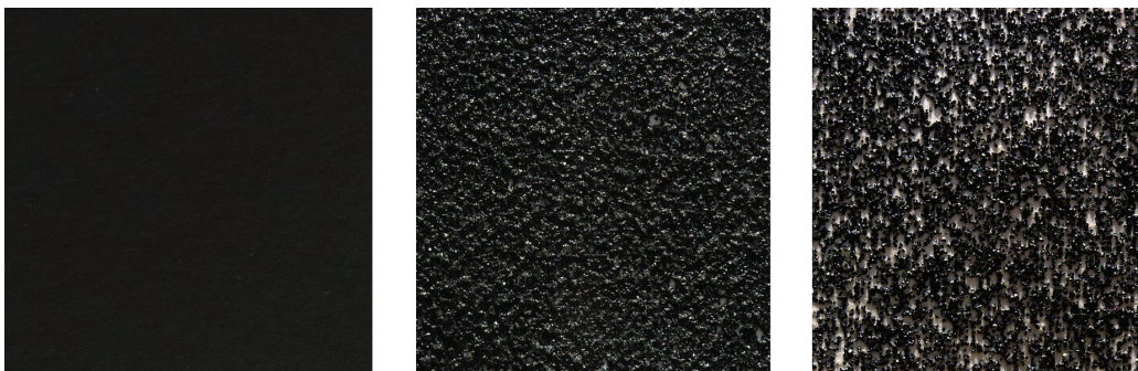
72 / Comparativa de la impresión de una tinta convencional (izq.) con una impresión por carga simple (dcha.) y por carga múltiple, en este caso doble (centro). En la impresión de áridos se ha empleado el mismo compuesto de carburo de silicio al 40% y látex. P5 Saturación / carga.
