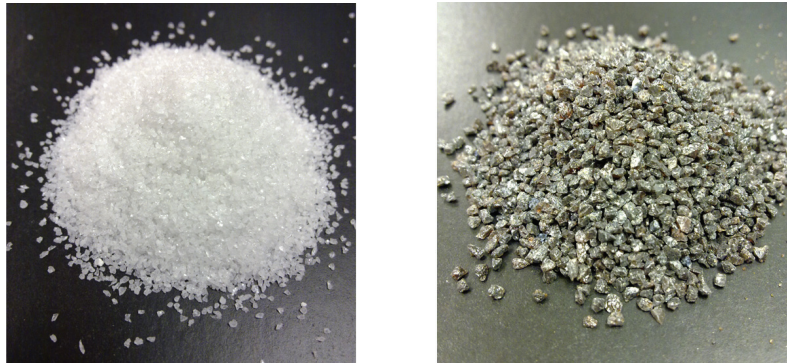
57 / Corindón de distintas granulometrías en sus versiones blanca y marrón.
