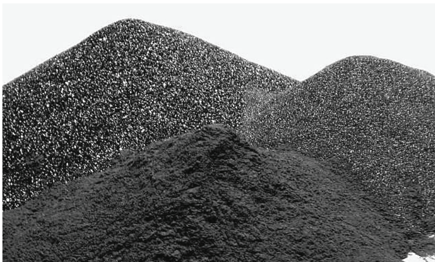
44 / Carburo de silicio negro en distintas granulometrías 80-180-500.
