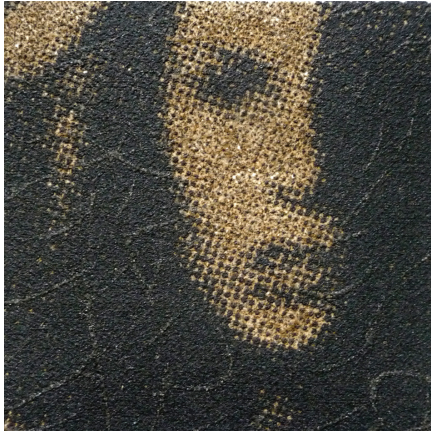
125 / Imagen elaborada mediante la impresión superpuesta de microesferas de vidrio, esferas de carbono, SiC 150 y vidrio granulado (en este orden). P14 Superposición áridos-1
