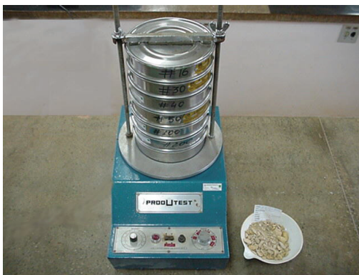
46 / Columna de tamices para la clasificación de áridos y diferentes partículas de 0,016 mm, a 2,0 mm.
