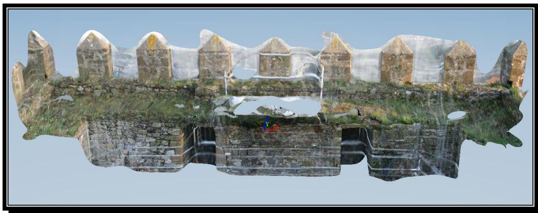
*Imagen D.5: Modelo generado con 17 puntos en común.*
