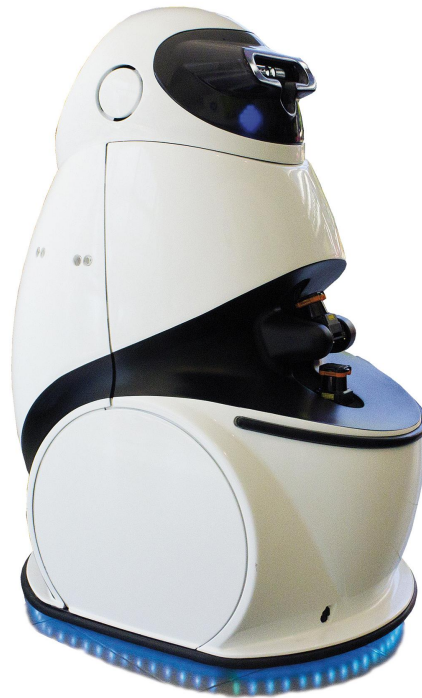
4.2. Irudia: Robotaren egitura, Segway RMP-a sentsoreekin
