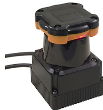
4.5. Irudia: Robotaren egitura, Hokuyo laser sentsorea
