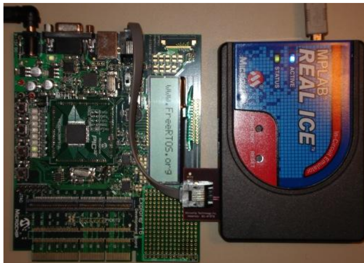
Imagen 28: Placa de desarrollo Explorer 16 junto a REAL ICE
