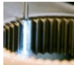
La rugosidad superficial que se obtiene en un proceso de electroerosión por penetración puede establecerse previamente, dentro de unos límites, al programar la máquina. Esta rugosidad puede variar dando lugar a un acabado muy rugoso o a un acabado sin rugosidad pero imposible de conseguir. Las tasas de arranque de material con electrodo de forma son del orden de  $2\text{ cm}^3/\text{h}$ .
