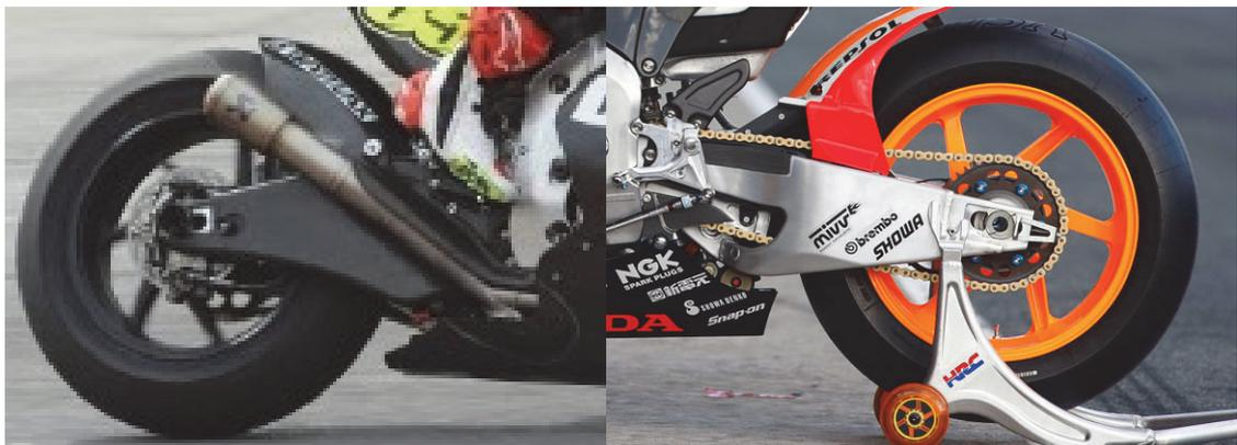
**Figura 3.249.** Basculante triangulada simétrica (izda.) y triangulada inferior (dcha.).
