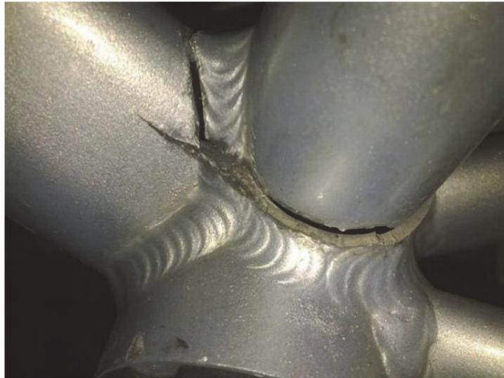
**Figura 3.235.** Fallo en chasis tubular por fatiga en unión soldada.
