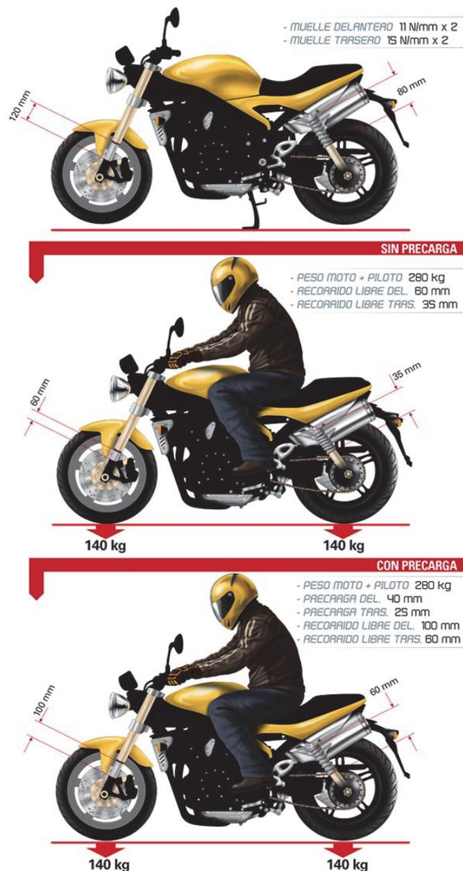
**Figura 3.47.** Efecto de la precarga sobre el recorrido de los muelles.
