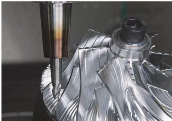
**Figura 3.242.** Superficies obtenidas con fresado frontal.
