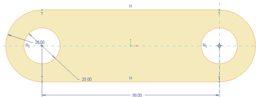
**Figura 3.176.** Configuración básica de la bieleta
