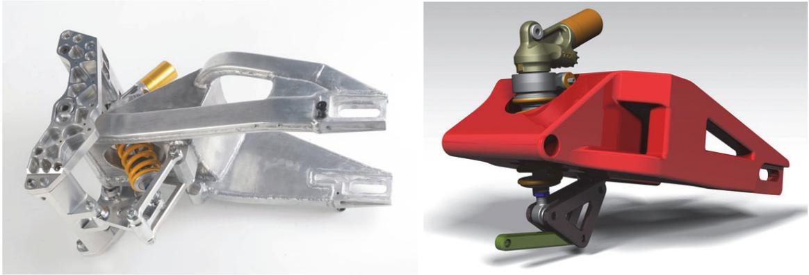
**Figura 3.251.** Sistema UniTrack de suspensión (izda.) y Pro-Link (dcha.).
