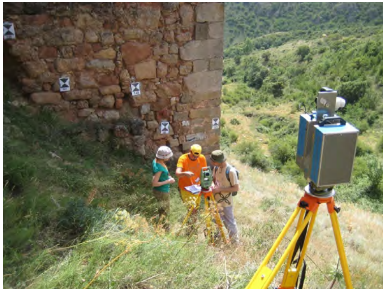
Fig. 9.20.- En primer plano a la derecha de la imagen se puede ver el equipo (láser escáner) utilizado para la captura de las nubes de puntos.
