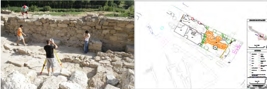
Fig. 3.3.- Dibujo de las unidades que representan una excavación arqueológica (LDGP, 2009b). En este caso, el responsable de la investigación arqueológica va describiendo las unidades que deben capturarse y el responsable de la documentación geométrica decide qué puntos se miden para realizar el plano. Visto de esta forma, se aprecia que el plano es un trabajo conjunto en el que el arqueólogo aporta la interpretación del espacio y el topógrafo aporta la representación gráfica.
