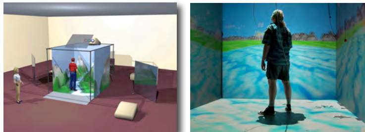
Figura 9. Modelo virtual (izq.) y ejecución (dcha) del sistema CAVE.
