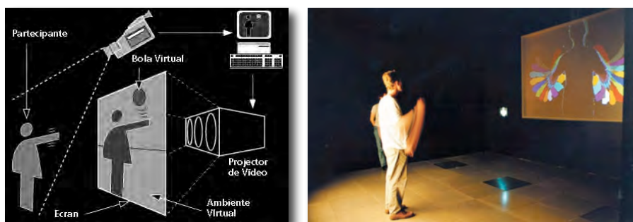
Figura 7. Esquema del funcionamiento de Videoplance (izq.), ejecución del sistema (dcha.)
