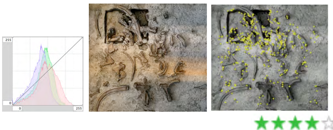
Figura 61. Histograma de los tres valores (RGB) correspondiente a la imagen optimizada, ortofotografía mejorada para ejercer de marcador y su valoración.
