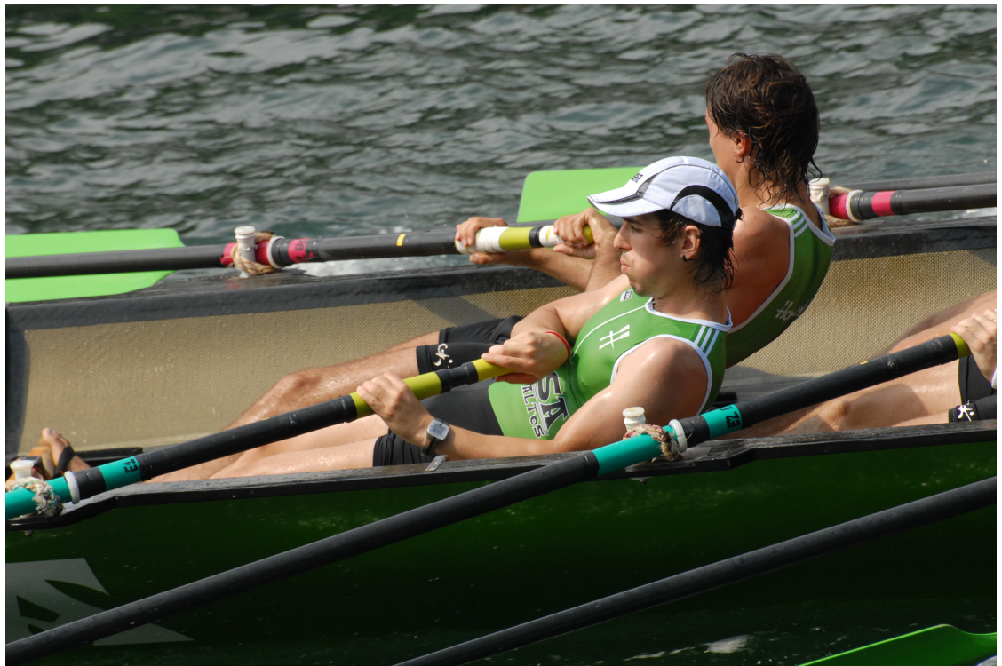
Figura 4.18: Remos anclados en el tolete con el estrobo a la altura del tope.
