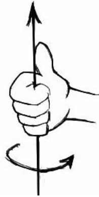
Figura 4.20: Representación gráfica de la regla de la mano derecha o sacacorchos.
