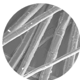
Fig.3 Fotografía microscópica del lino 484 microscopio electrónico (MEB)
