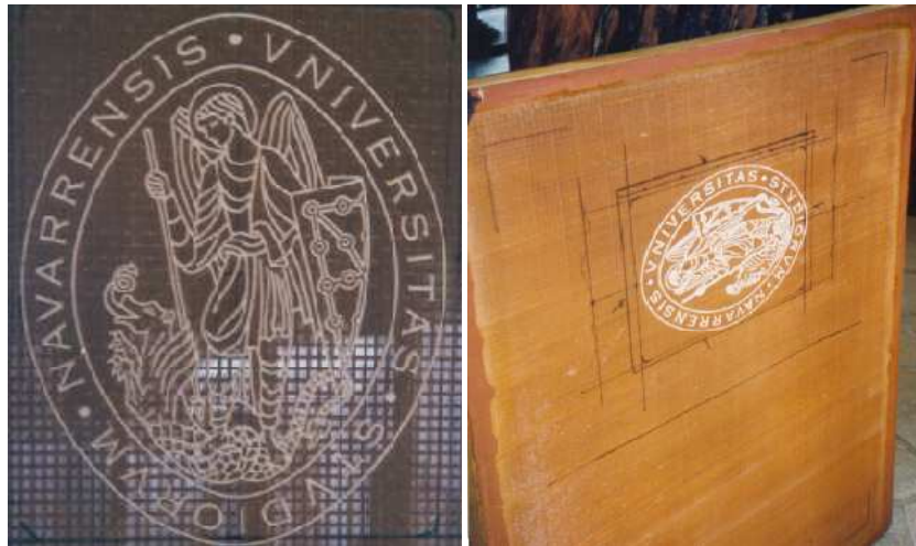
Figuras 3 y 4. Molde adherido a la malla que dará como resultado la marca al agua del papel.
