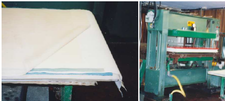
Figura 14 (izquierda). Pila de papeles intercaladas con fieltros y telas. Figura 15 (derecha). Prensa hidráulica
