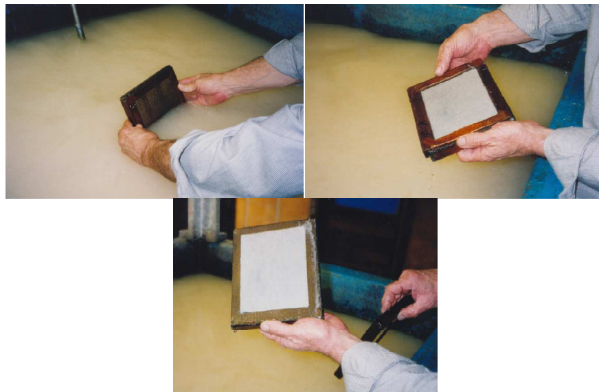
Figuras 9,10 y 11. Fotografías de los diferentes pasos a seguir en la fabricación de papel.
