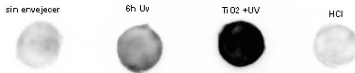
Figura 8. Papeles sin lavar antes de depositar 0,04mg/ml de GOD. Foto de un minuto de exposición en la cámara CCD
