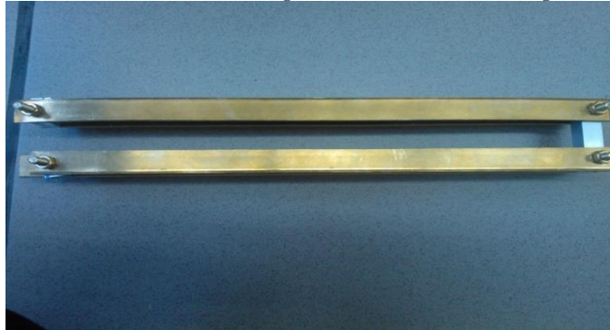
Figura 2-3. Láminas de latón para la sujeción de las planchas de hierro.
