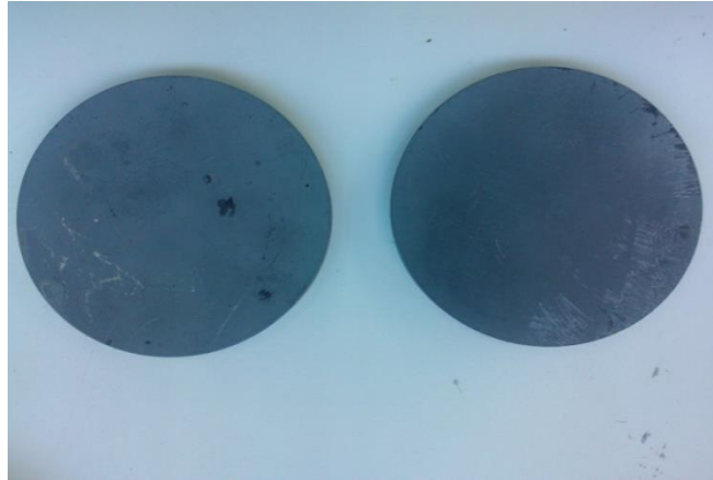
Figura 2-2. Planchas de hierro para aumentar el campo magnético.
