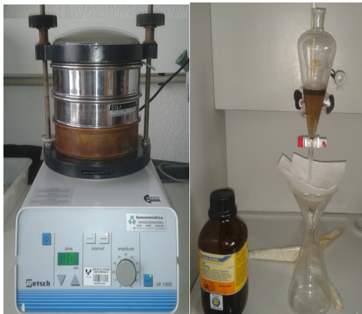
7. Irudia. Bahe-tresna bibratzailea (eskuinean) eta dekantazio zutabea: goiko partean dekantazio inbutua, ondoren inbutua, barruan iragazpapera eta behean matrazea (ezkerrean).
