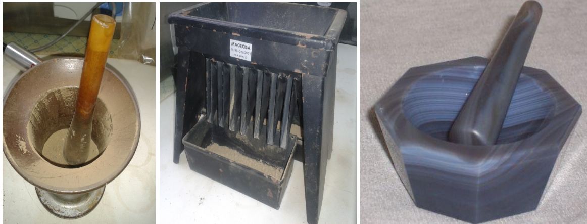
6. Irudia. Laginak disgregatzeko burdinezko motrailua (ezkerrean), kuartheadorea (erdialdean) eta agatazko motrailua (eskuinean).
