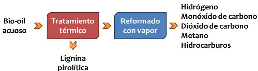
**Figura 1.7.** Proceso de dos etapas para el reformado de bio-oil completo (Remiro, 2012).
