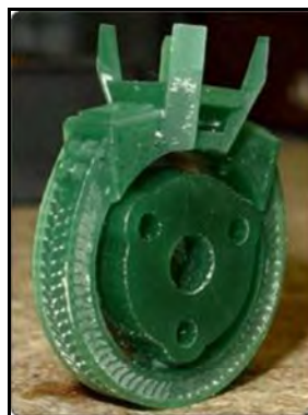
Cera producida en un CNC o Prototipado Rápido
