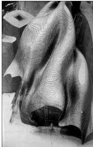
Modelo físico de capas de papel y resina (LOM) para la Residencia Lewis
