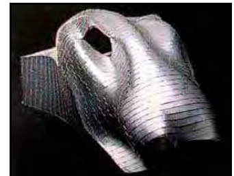
Modelo físico final LOM
