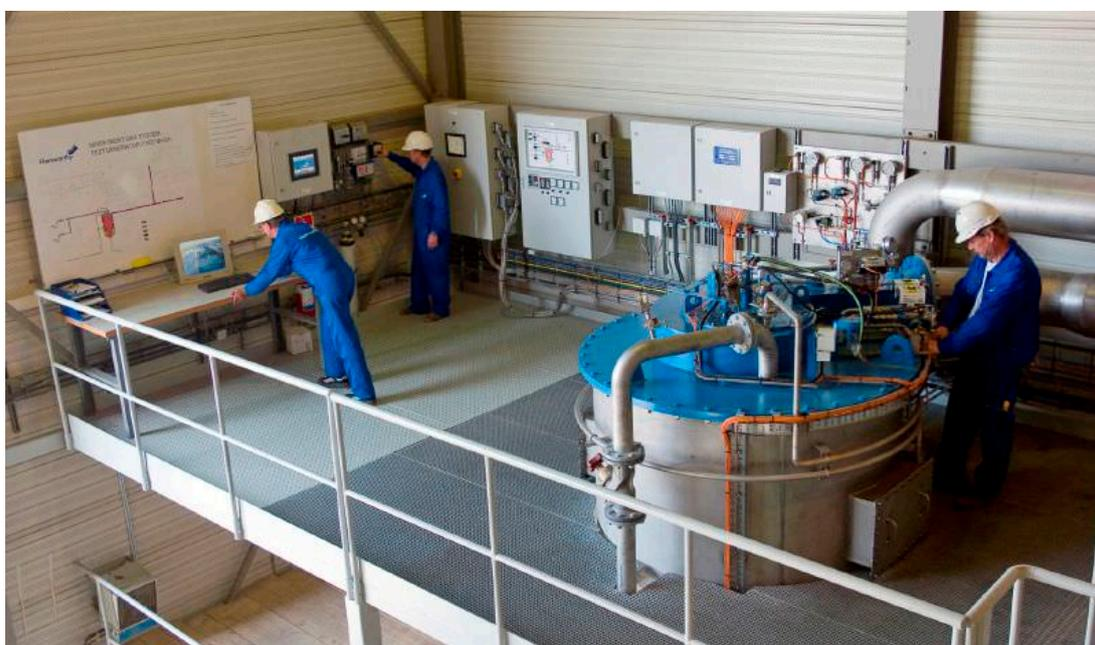
**Figura 11:** Planta de generación de gas inerte en un buque tanque.
