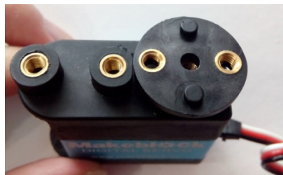
Irudia 3.5.9. Serbomotorearen ardatzaren kokapena
