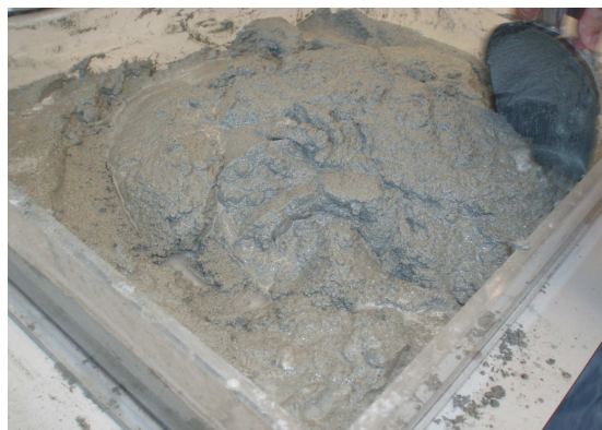
Figura 82. Escoria blanca tras pulverizar la mitad de la cantidad establecida
