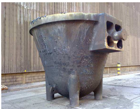
Figura 52. Cono de vertido de escoria EAF caliente [Arribas, 2011]
