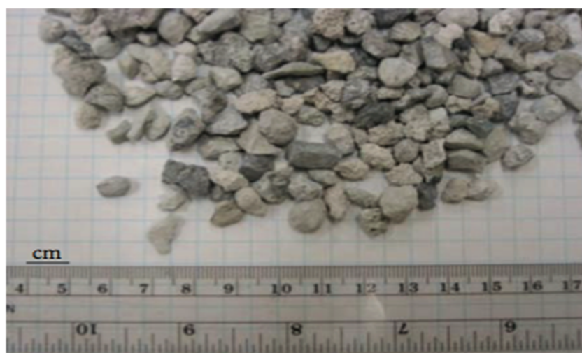
Figura 21. Partículas de tamaño grava de la LFS saturada en alúmina [Yildirim y Prezzi, 2011]
