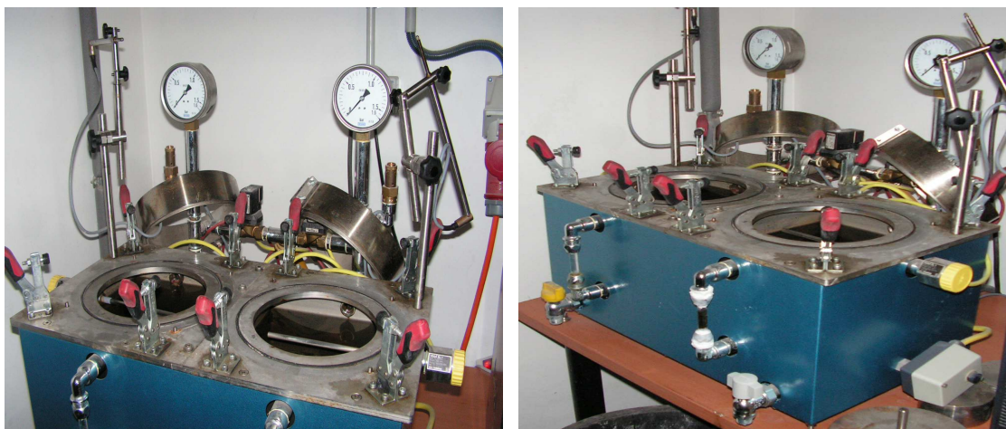
Figura 66. Equipo para la determinación de la expansión de escorias SBG 4500 N/C
