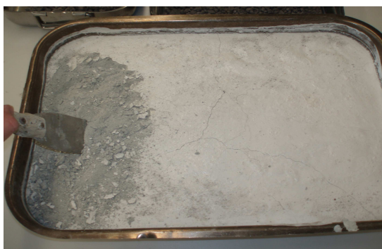
Figura 85. Estado de la escoria blanca tras el secado y volteo en estufa a 60°C
