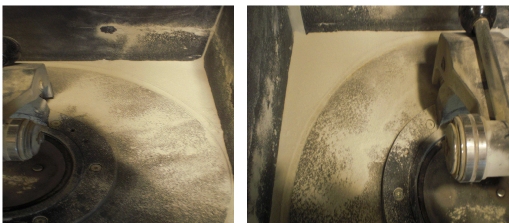
Figura 99. Fracción de EB1 expulsada al abrir la mordaza tras largos tiempos de molido
