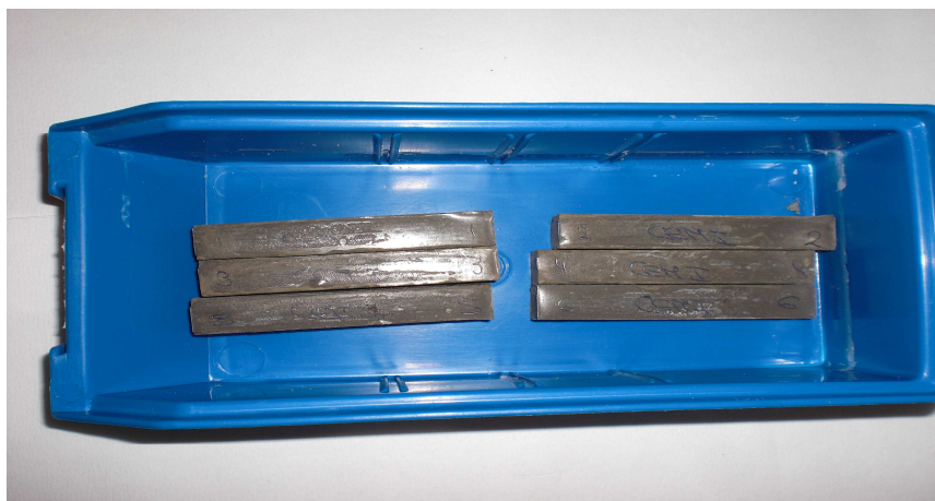
Figura 105. Probetas desmoldadas para su curado, previo a su cubrimiento con agua
