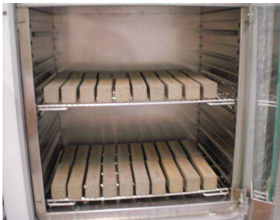
Figura 164. Probetas tras 6h en cámara climática
