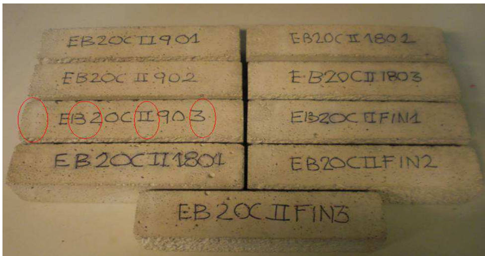
Figura 170. Líneas presentes en probetas con 20% de sustitución de cemento (CEM I) por EB1
