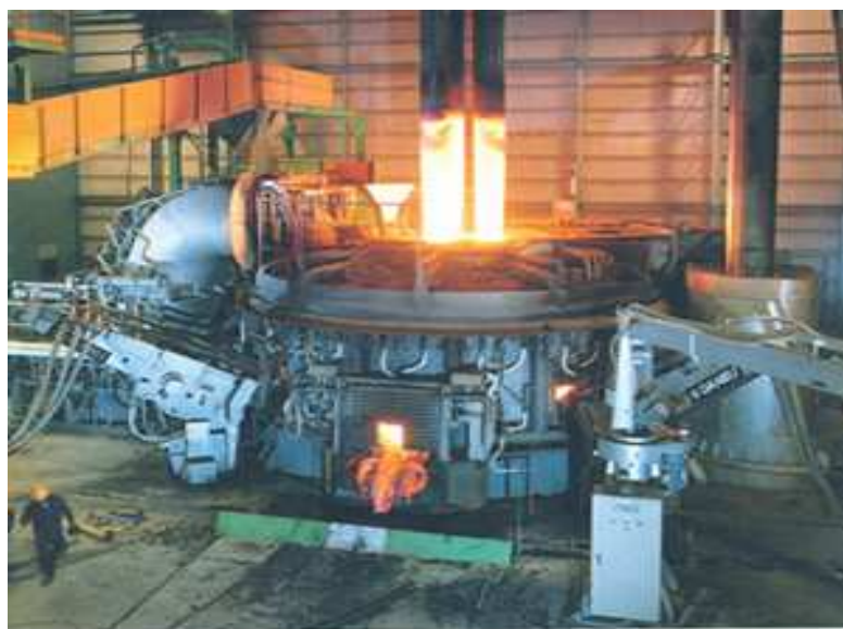
Figura 9. Horno eléctrico de arco [UNESID, 2002]
