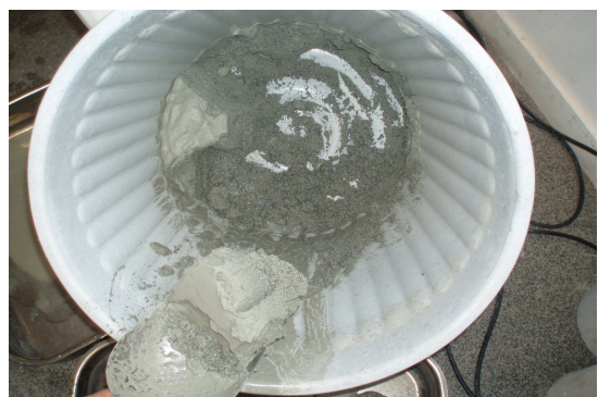
Figura 76. Retirada de agua sobrenadante
