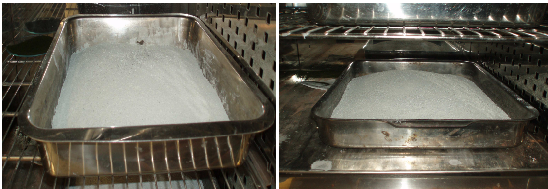
Figura 96. Escoria blanca en estufa a 60°C tras machacado y tamizado <2mm.
