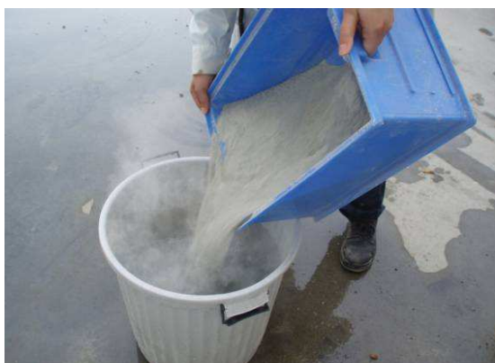
Figura 74. Vertido de la escoria blanca sobre 25 l de agua
