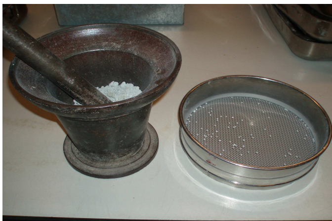
Figura 95. Equipo de machaqueo (izq.) y tamiz de luz de malla 2mm (dcha.)
