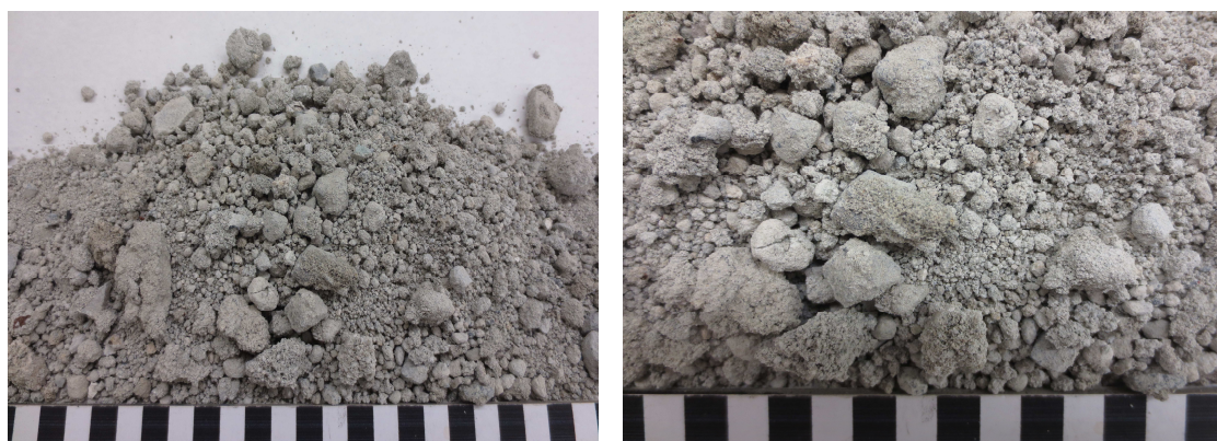
Figura 54. Muestra de escoria blanca EB1 (escala en cm)
