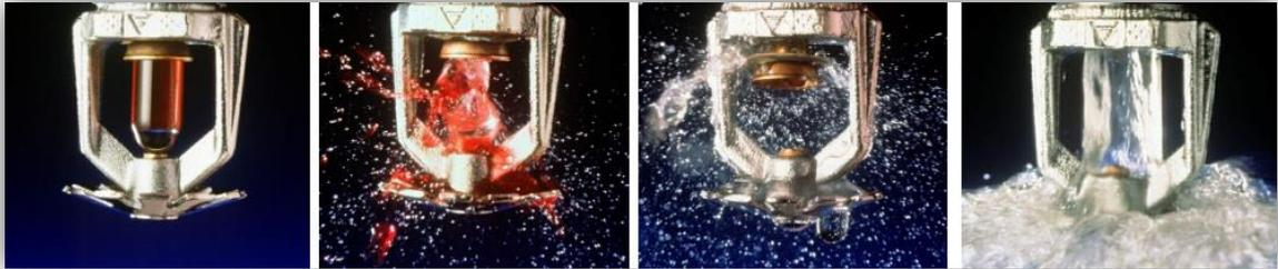
Figura 23. Secuencia de activación de un rociador automático [34]
