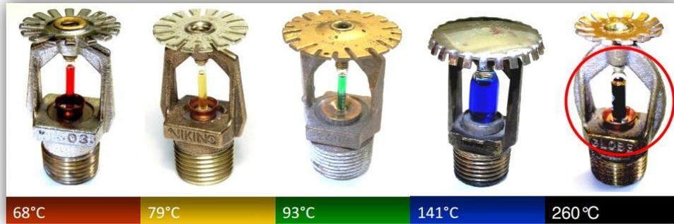
Figura 24. Relación de colores de ampollas y temperaturas a las que explotan [34]
