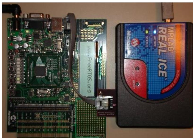
Figura 14: *Debugger* Real Ice conectado al microcontrolador mediante Explorer 16
