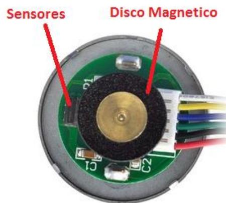
Figura 24: Vista posterior del motor donde se observa el *encoder*
