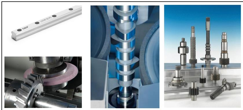
*Fig. 1 Ejemplos de piezas que requieren de una operación de rectificado.*
