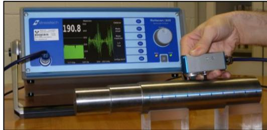
Fig. 137 Medición de la señal de ruido Barkhausen sobre una pieza cilíndrica.
