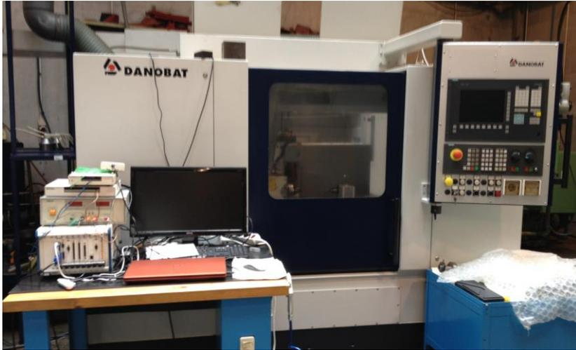
Fig. 132 Rectificadora plana modelo FG-600-S del fabricante Danobat®.
