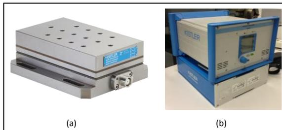
Fig. 104 Dinamómetro Kistler modelo 9257B (a) y amplificador Kistler 5070A (b).
