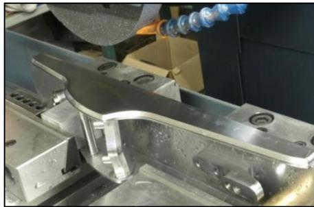
Fig. 7. Rectificado de una superficie plana (fuente Holtey)
