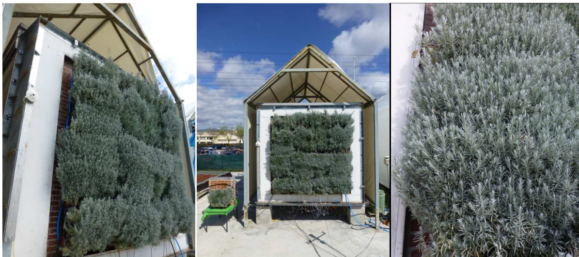
Fig. 5. 27. Fotografías de la fachada vegetal el día de la realización de las fotografías termográficas (27-03-2014). Izda.: detalle del marco perimetral aislante Centro: visión completa de la fachada vegetal. Dcha. Detalle del desarrollo vegetativo
