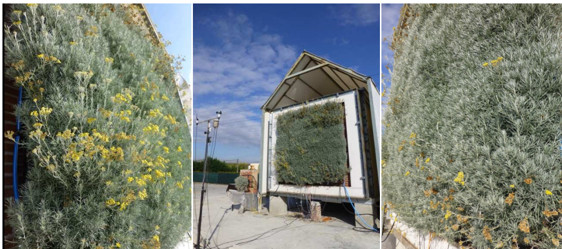
Fig. 4. 23. Detalle de la fachada vegetal en Octubre de 2013 durante los ensayo PRBS en la célula de ensayo ILARGI
