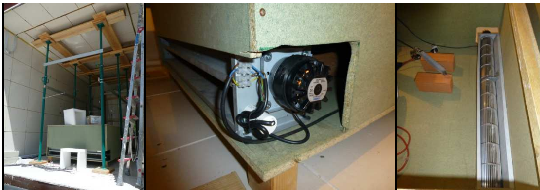
Fig. 3. 35. Izquierda: Vista general de sala de ensayo sin la pared sur. Centro: Detalle del motor axial del ventilador. Derecha: el ventilador y la resistencia eléctrica en el interior caja de madera
