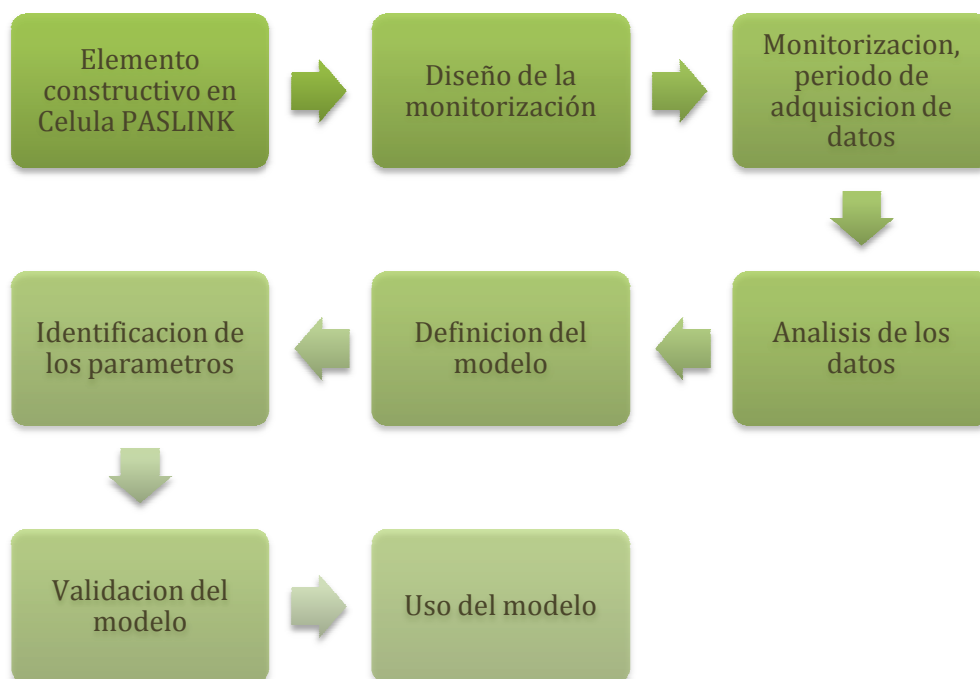
Fig. 2. 13. Pasos en el desarrollo de diseño, monitorización, identificación y validación de modelos matemáticos en células Paslink
