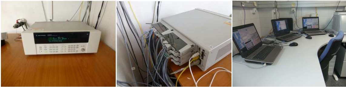
Fig. 3. 16. Detalle delantero y posterior del adquisidor de datos HP Agilent 34980A para el registro y control de las pruebas PASLINK: Izquierda. HP Agilent 34982 se conecta a un ordenador donde se almacenan los datos y se envía por correo electrónico a los investigadores en el formato " dayfiles". Derecha: la interfaz del programa desarrollado para el registro y control de las pruebas PASLINK
