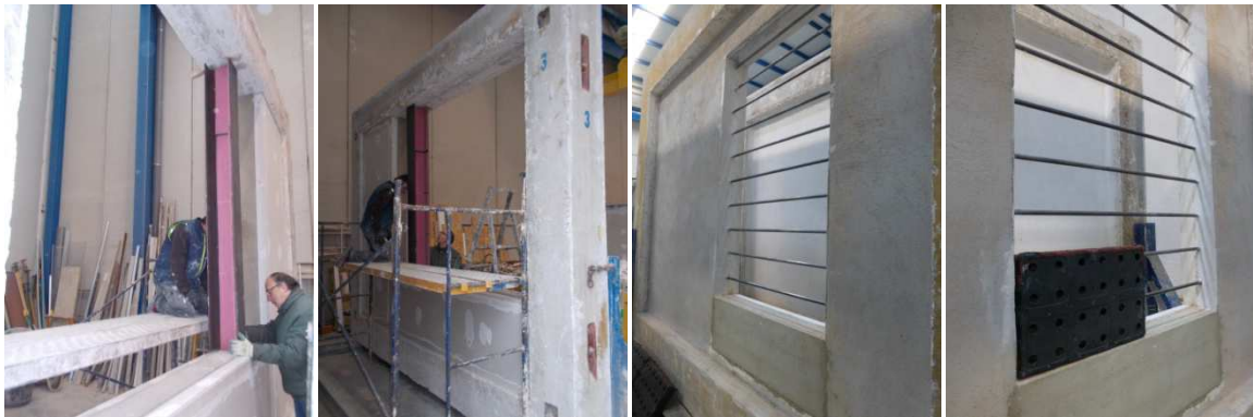
Fig. 6. 1. Detalle del levante del cerramiento utilizado en el ensayo de aislamiento acústico.
