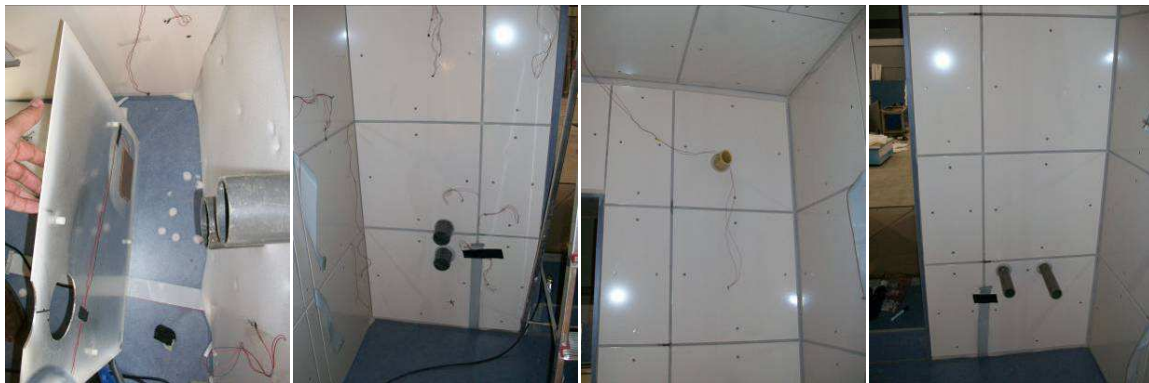
Fig. 3. 39. Izda.) Se pueden observar completamente alineadas e instaladas las HFS Tiles sobre la capa de espuma Dcha.) las paredes y techo recubiertos por las Tiles
