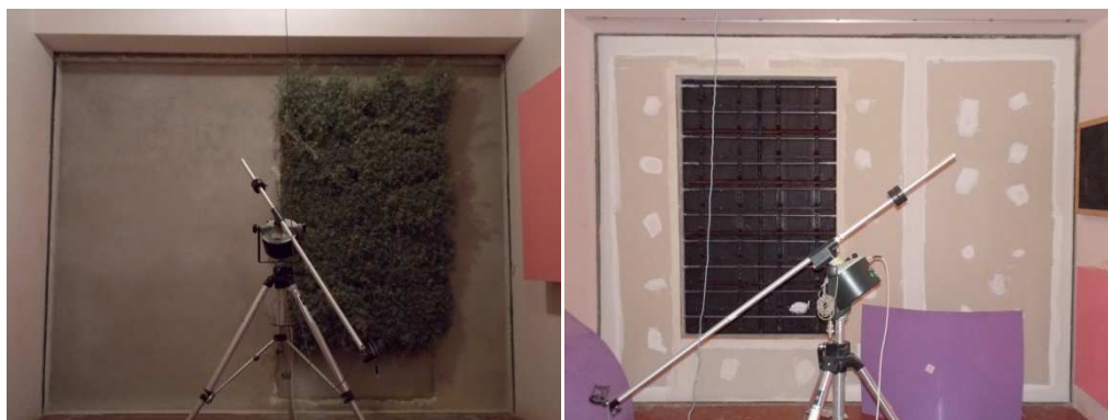
Fig. 6. 4. Arriba: Croquis de las salas de transmisión horizontal, cámara emisora y cámara receptora. Disposición de micrófonos, fuentes sonoras y muestra. Abajo. Imagen del momento de ensayo realizado de las salas de transmisión horizontal, por ambas caras.
