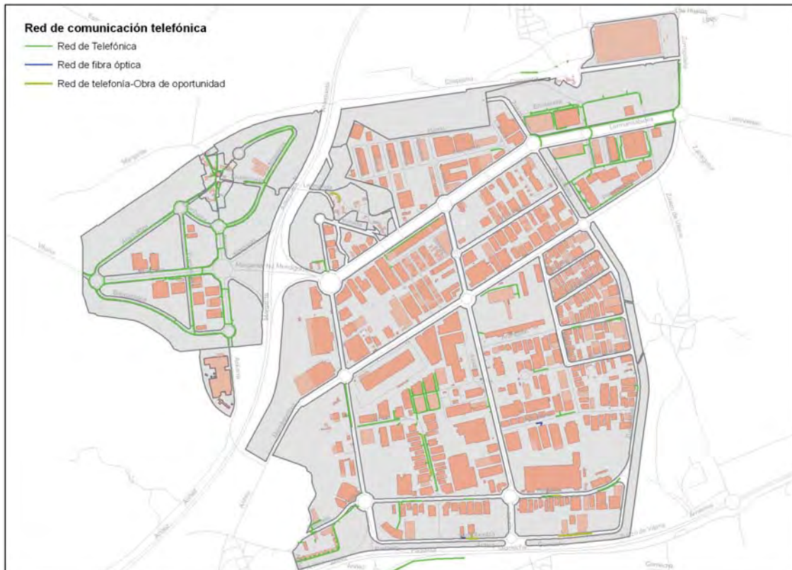
Figura 8.11: Red de telefonía en el polígono de Jundiz Fuente: Elaboración propia
