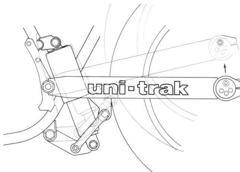
Figura 3.5.4. Sistema de suspensión Uni-Trak.
