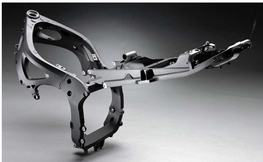
Figura 3.4.8. Chasis de tipo doble viga.
