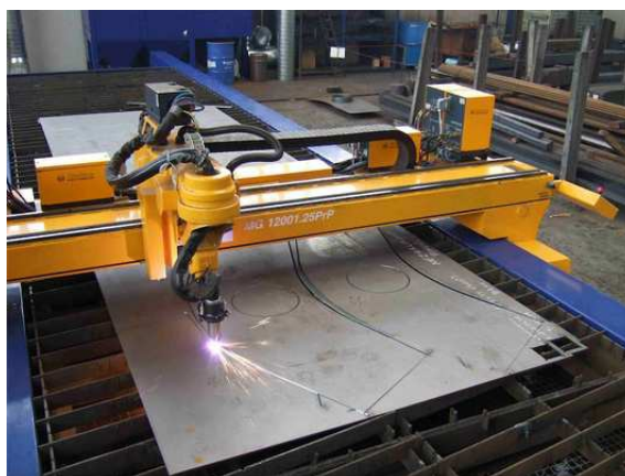
Figura 3.8.2. Máquina empleada para el corte por plasma.
