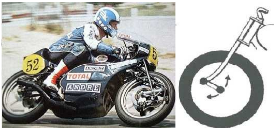
Figura 3.4.14. Suspensión del tren delantero mediante sistema de rueda tirada.
