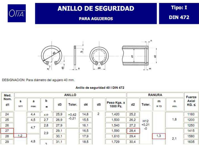
Figura 3.6.59. Anillos de seguridad DIN 472.
