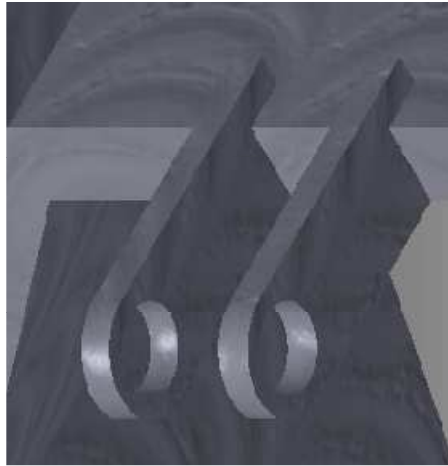
Figura 3.7.13. Orejas del basculante.
