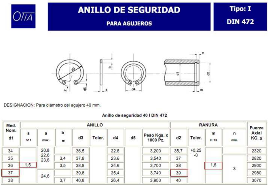
Figura 3.6.56. Anillos de seguridad DIN 472.
