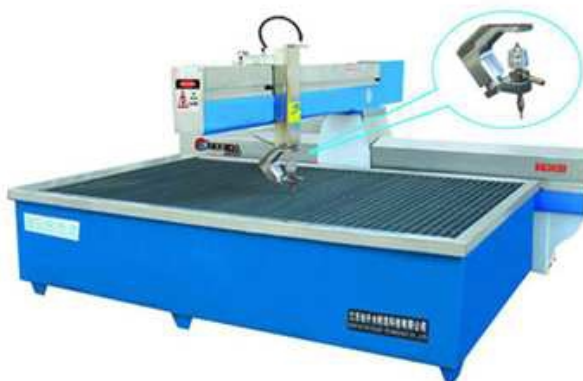
Figura 3.8.3. Máquina de corte por chorro de agua.
