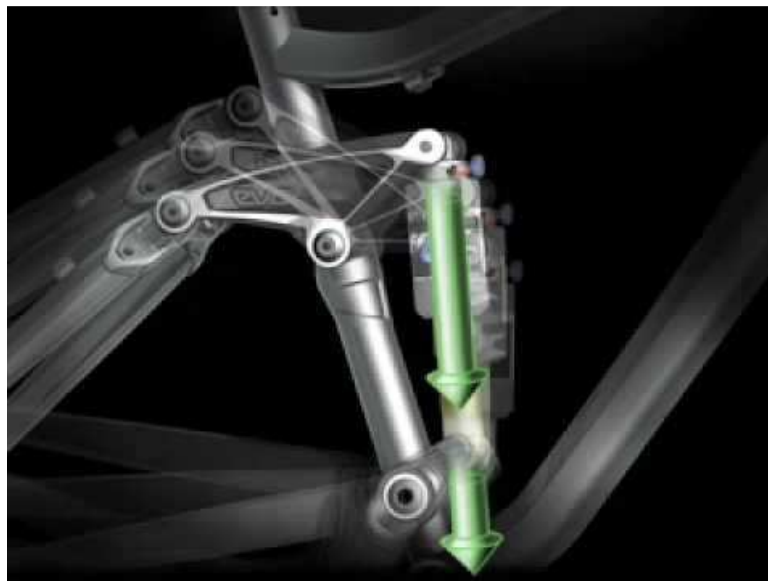
Figura 3.5.2. Sistema de suspensión Full-floater.
