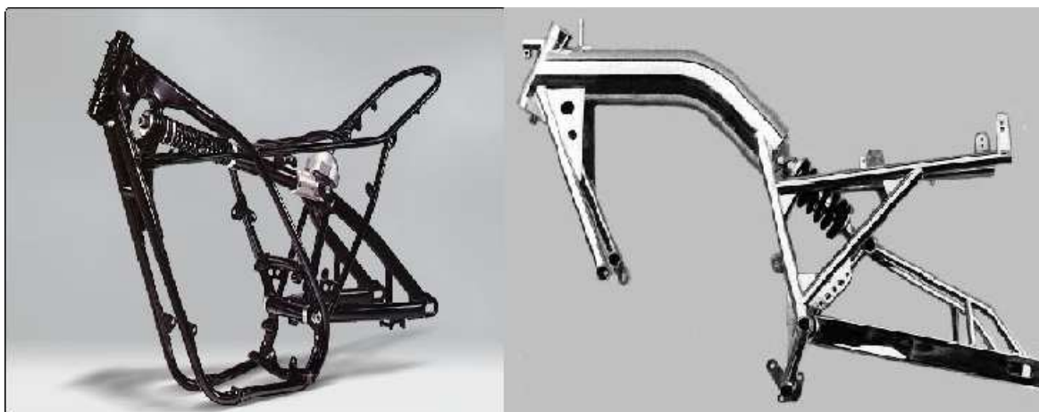
Figura 3.4.20. Cantilever (izquierda) y monoshock (derecha)
