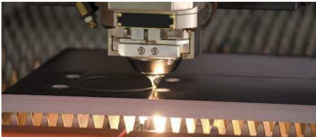
Figura 3.8.4. Máquina de corte por laser.
