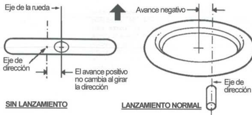
Figura 3.4.27. Valores de avance para diferentes lanzamientos.
