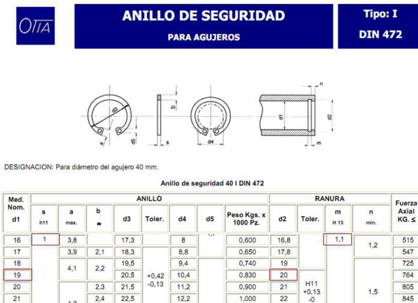
Figura 3.6.60. Anillos de seguridad DIN 472.
