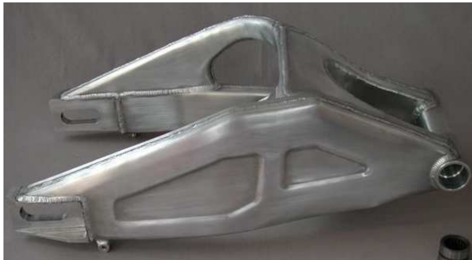
Figura 3.5.9. Basculante doble brazo tubular
