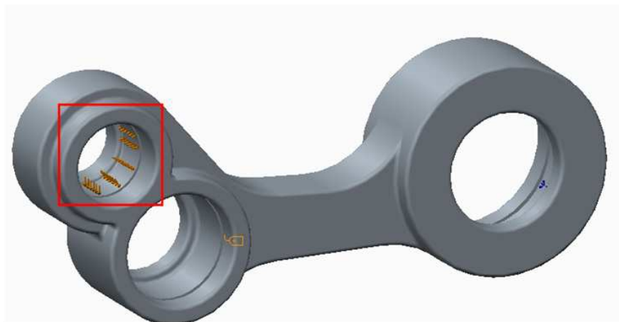
Figura 3.6.97. Carga aplicada correspondiente a la reacciones con la bieleta.
