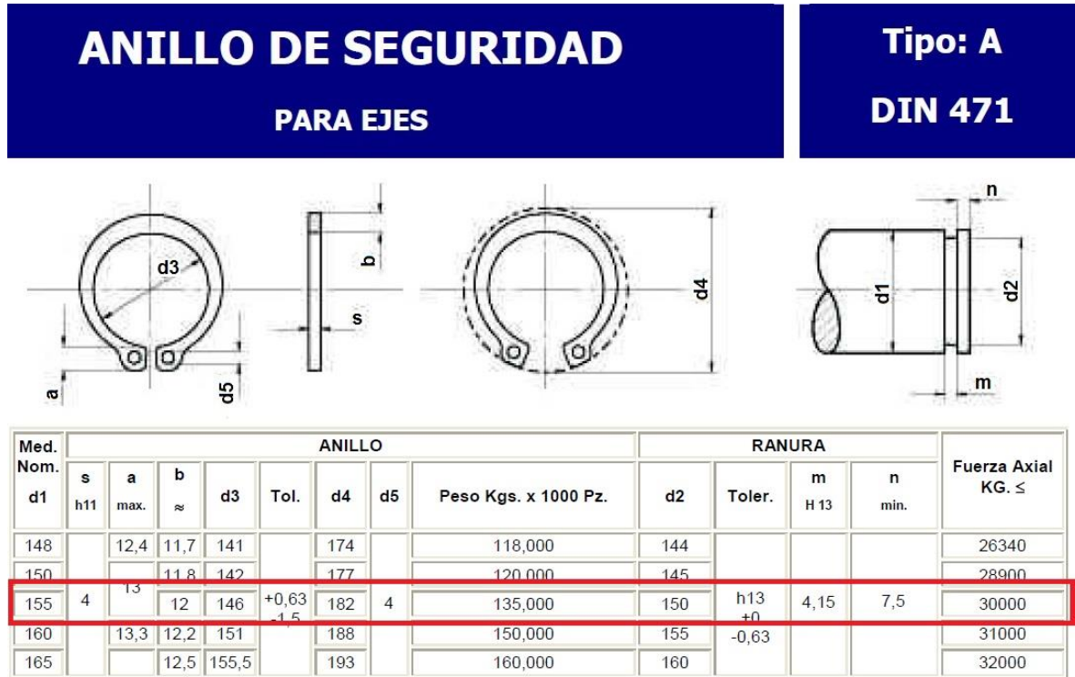
Figura 85. Características del anillo de seguridad
