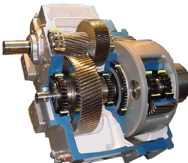
Figura 35. Caja multiplicadora de ejes paralelos
