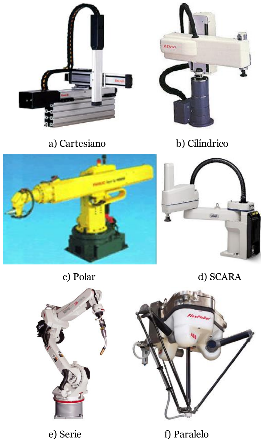
Figura 7: Tipos de robots industriales según su estructura.
