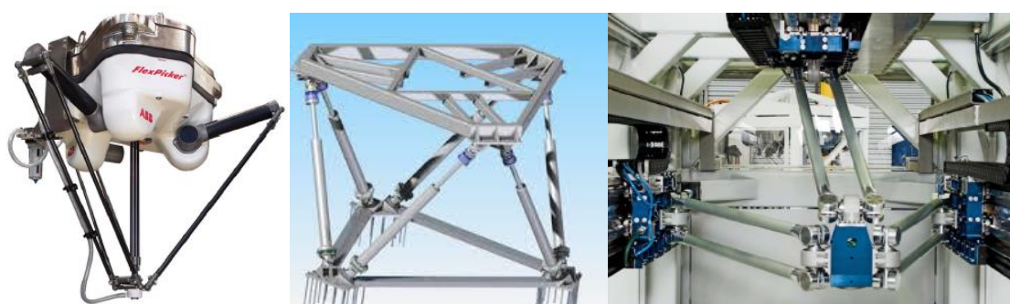
Figura 8: Ejemplos de estructuras de robots paralelos.
