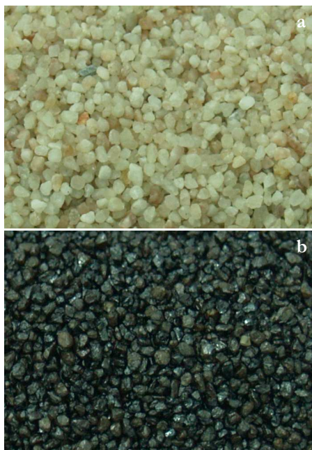
Figura 3.2. Imágenes de la arena fresca (a) y utilizada en la pirólisis de PET (b).
