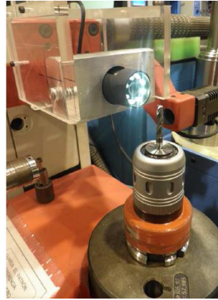
Figura 4.34. Posición de la herramienta para la medida con la cámara de alta resolución
