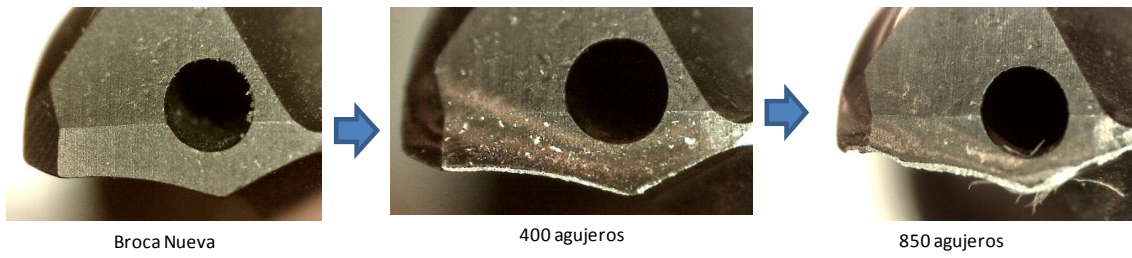
Figura 4.110. Evolución del desgaste de flanco en la herramienta, a medida que se taldran agujeros
