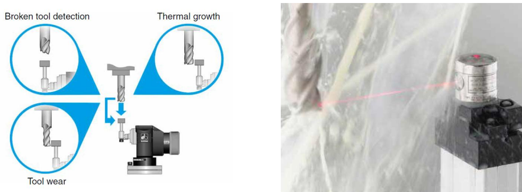
Figura 2.79. Sonda de verificación de herramientas por contacto y sin contacto [167]
