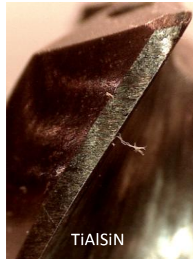
Figura 4.76. Imagen de la cámara de alta resolución del filo de la broca recubierta con TiAlSiN en la que se medirá el desgaste de flanco
