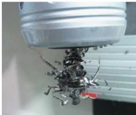
Figura 4.67. Enmarañamiento de la viruta ocasionado en la broca recubierta con AlTiCrN
