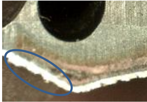
Figura 4.85. Material adherido al filo de la herramienta recubierta con AlCrN
