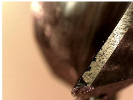
Figura 4.50. Pérdida de recubrimiento en los filos secundarios al aumentar el número de taladros realizados
