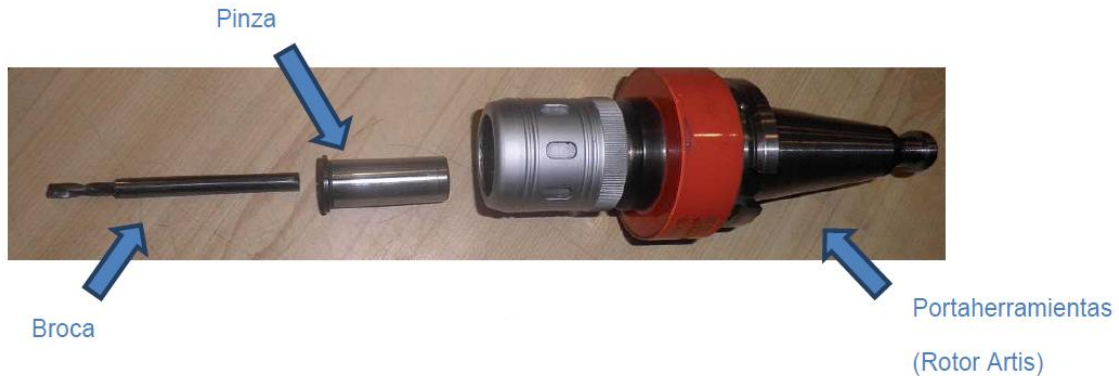
Figura 4.32. Montaje de broca, pinza y portaherramientas Artis
