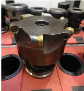
Figura 4.17. Fresa y plaquitas utilizadas para el planeado
