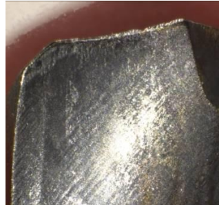
Figura 4.111. Superficie de desprendimiento de la broca recubierta AlTiSiN-Mejorado tras 850 operaciones
