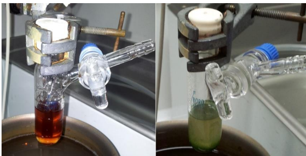
Figura 4.8. Síntesis del homopolímero S vía ATRP. Comienzo de la síntesis (izda.), fin de la síntesis (dcha.)
