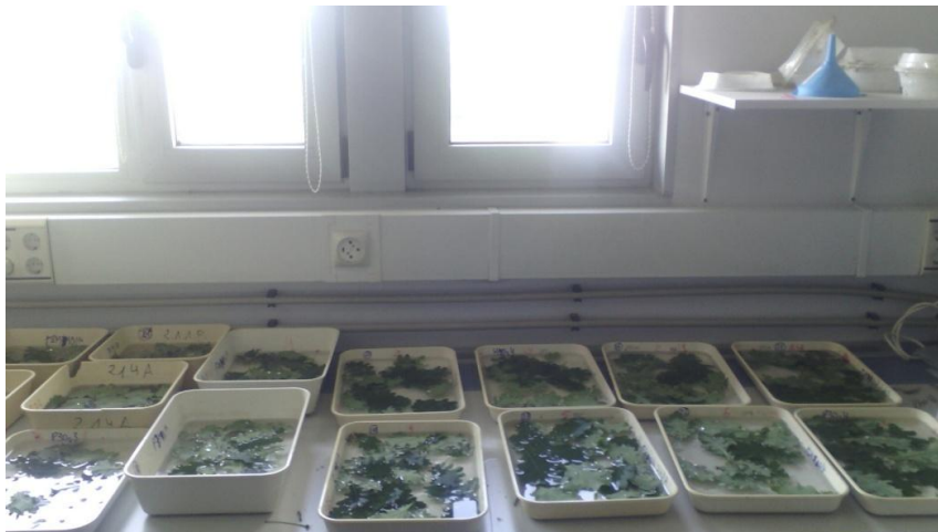
Figura 7. Muestras de hojas del dosel arbóreo sumergidas en agua en el laboratorio.
