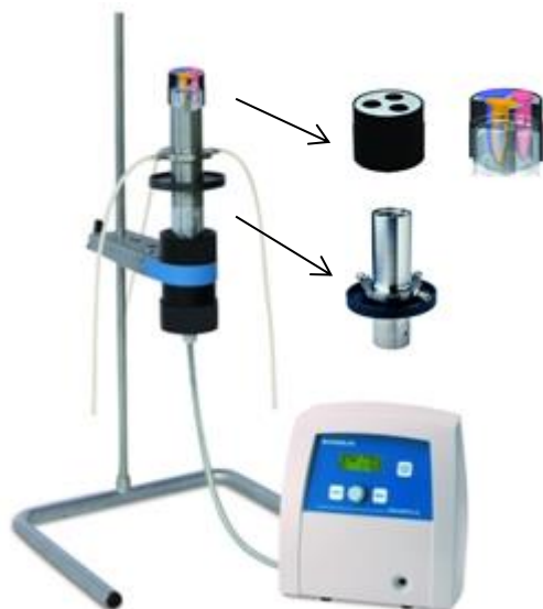
3. Irudia. FUSE-ren egitura cup booster -arekin.
