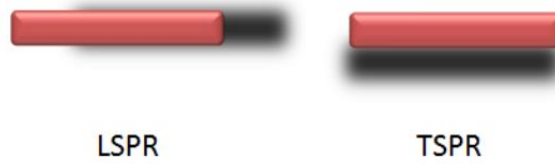
Figura 1.3.- Representación esquemática de la resonancia de los electrones superficiales a lo largo del eje longitudinal y transversal de los nanocilindros.
