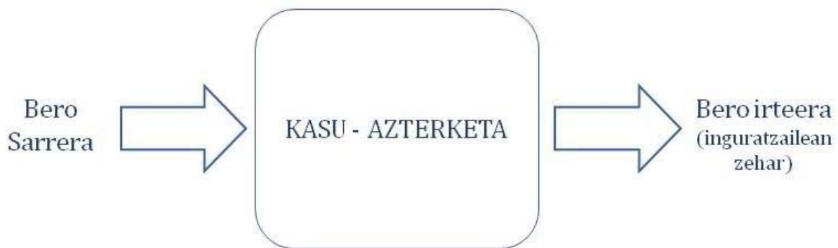
14.46. Co-heating metodoaren printzipioaren eskema
