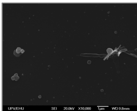
Figura 25. Imagen SEM de partículas de ácido maleico internamente mezclado con NaBr.
