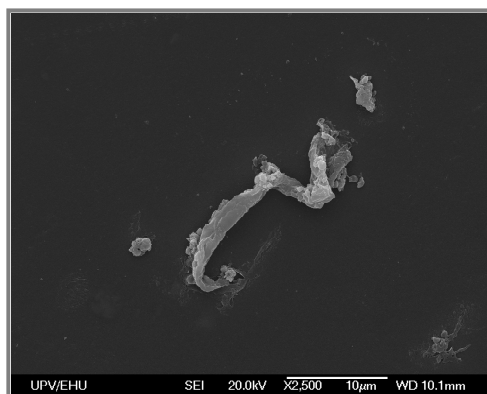
Figura 11: Imagen SEM de partículas de aerosol de ácido láurico puros.
