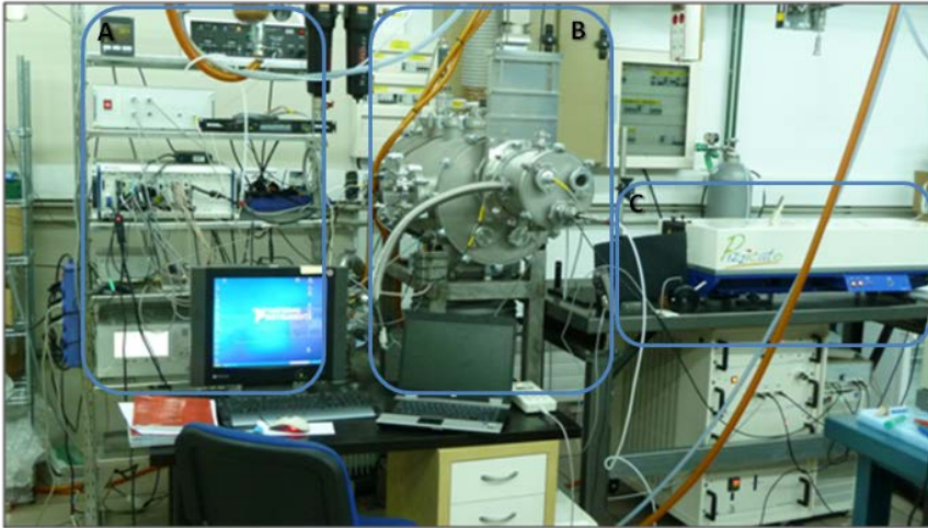
Figura 6: Aspecto general del espectrómetro de FTMW
