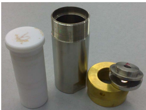
Figura A.1. Recipiente de teflón y carcasa de acero empleados en la síntesis a presión y temperatura moderadas.
