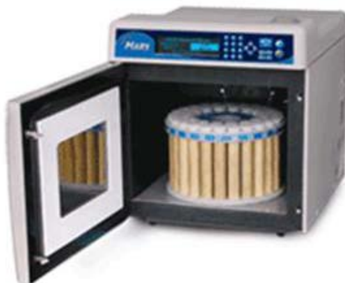
Figura A.2. Microondas CEM MARS 5 empleado en la síntesis asistida por microondas.
